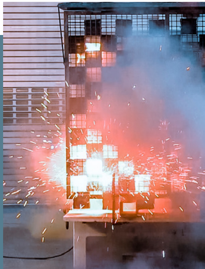
Störlichtbogenprüfung nach IAC-A für Bediener 20 kA 1s
