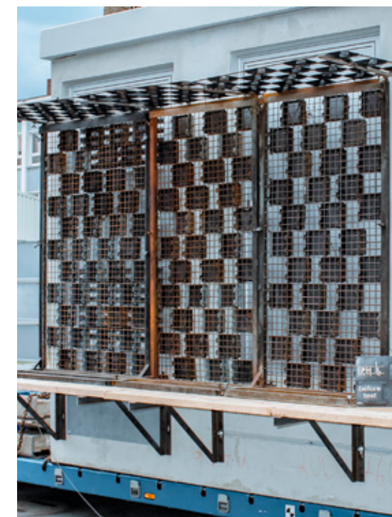
Störlichtbogenprüfung nach IAC-B für Passantenschutz 20 kA 1s
