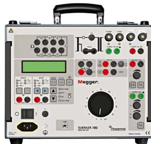
Durchführung einer Schutzprüfung mit Sekundärprüfeinrichtung
