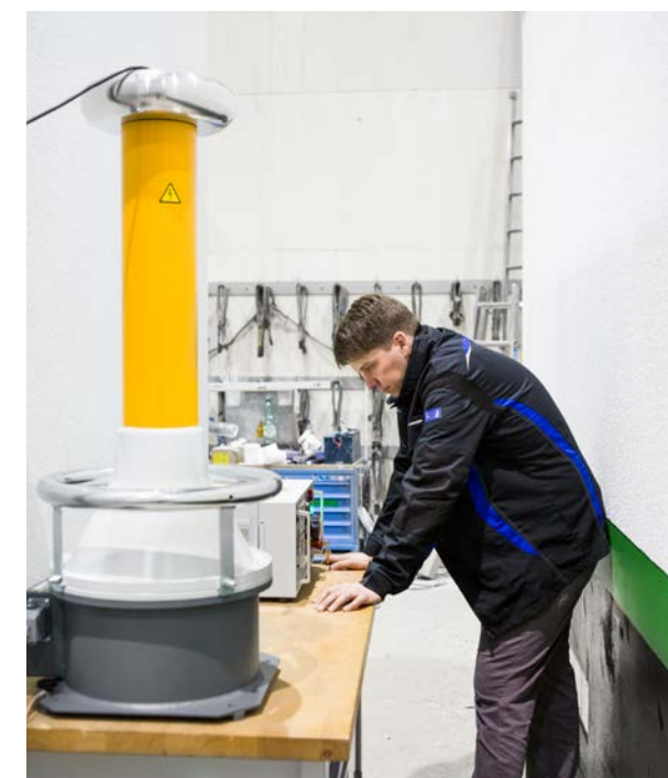
Steh-/Wechselspannungsprüfung an einer luftisolierten MS-Schaltanlage vor der Auslieferung
