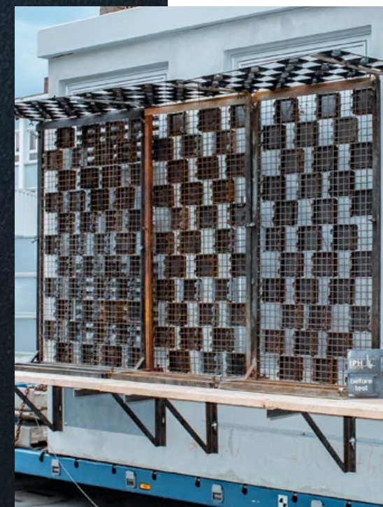
Störlichtbogenprüfung nach IAC-B für Passantenschutz 20 kA 1s
