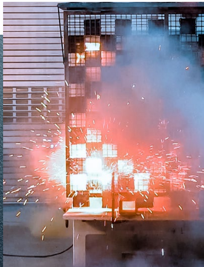
Störlichtbogenprüfung nach IAC-A für Bediener 20 kA 1s
