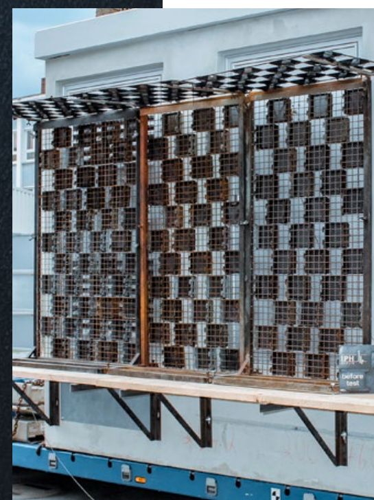
Störlichtbogenprüfung nach IAC-B für Passantenschutz 20 kA 1s
