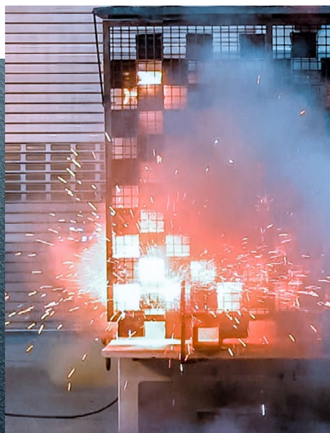
Störlichtbogenprüfung nach IAC-A für Bediener 20 kA 1s
