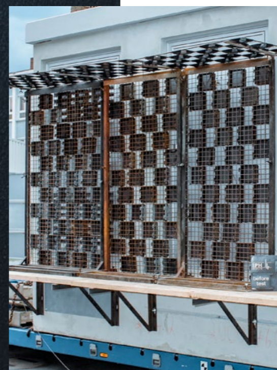
Störlichtbogenprüfung nach IAC-B für Passantenschutz 20 kA 1s
