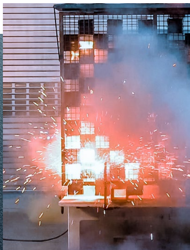
Störlichtbogenprüfung nach IAC-A für Bediener 20 kA 1s
