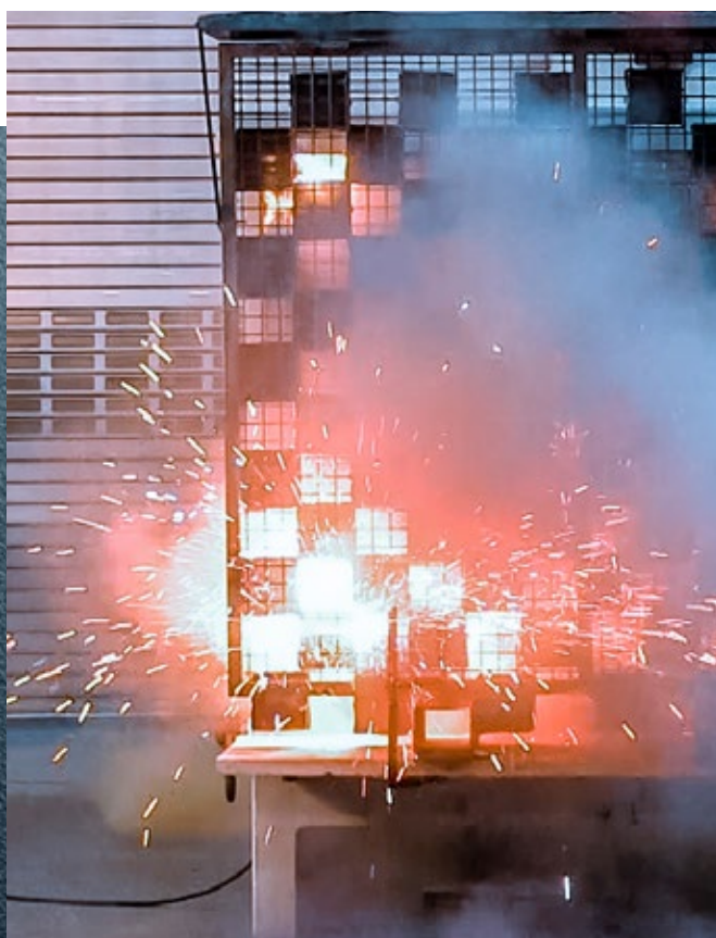
Badanie odporności na wewnętrzne zwarcie łukowe zgodnie z IAC-A (20 kA/1 s)
