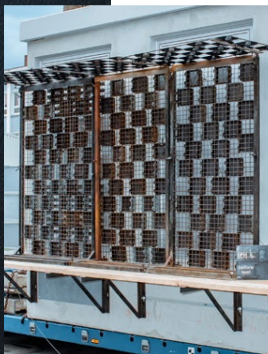
IEC-B ív rövidzárlati teszt [20 kA/1s]
